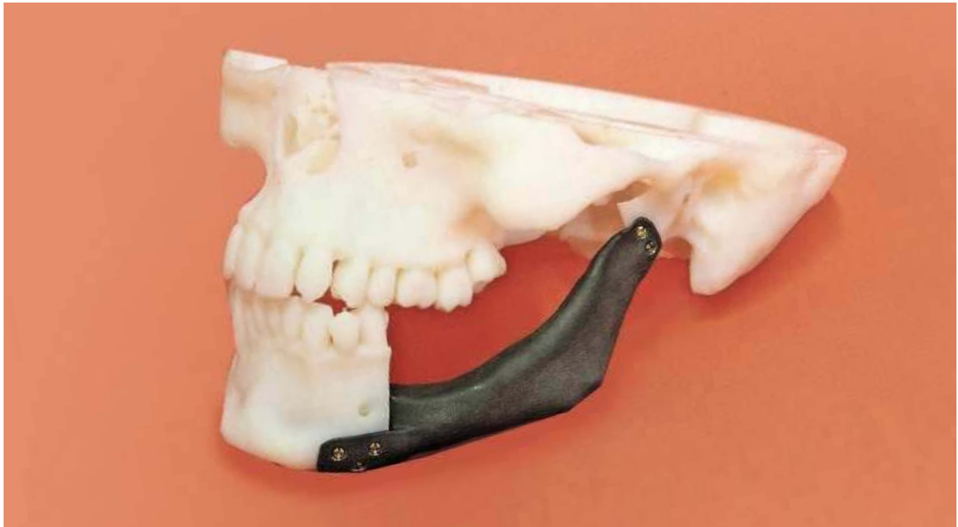
Knochenplatte aus dem 3-D-Drucker der Basler Firma Mimedix: Komplexe, individuelle Lösungen
